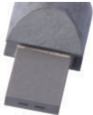
Rectangular diamond dresser 2 x 0,3 x 1,5 mm, Total bearing surface 0,9 mm 2 , r = 0,14 mm
